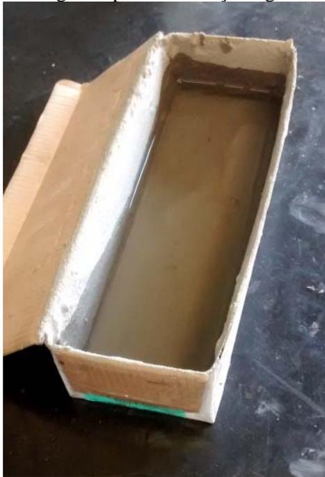
Figura 3: teste de estanqueidade lâmina d'água impermeabilização flexível
